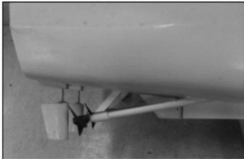
Gambar 7. Bentuk dan Modifikasi Skeg pada Model Uji
