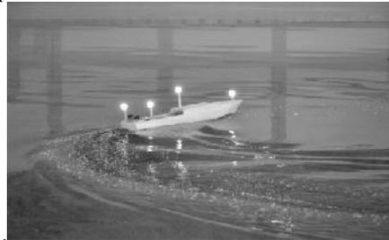
Gambar 9. Pengujian Vs 28 knot, skeg 15 deg
